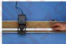
图 14-3 用打点计时器测量手拉纸带的速度
